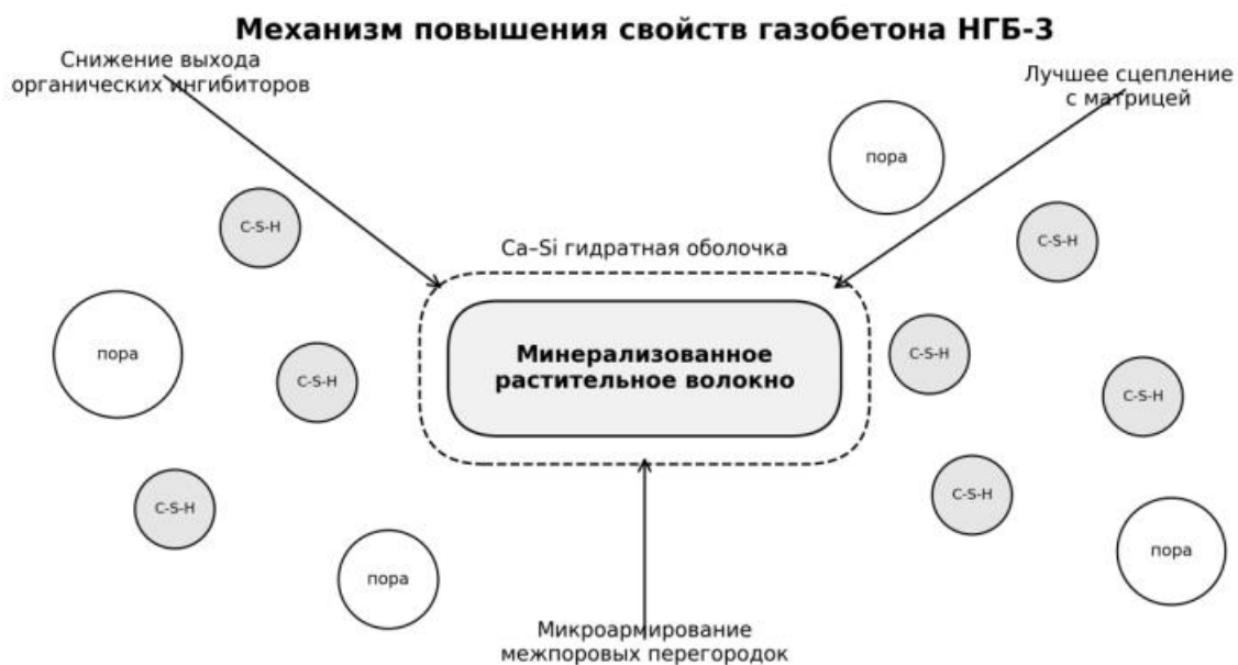
Рисунок 7 - Предполагаемый механизм повышения свойств газобетона за счет минерализованного волокна
