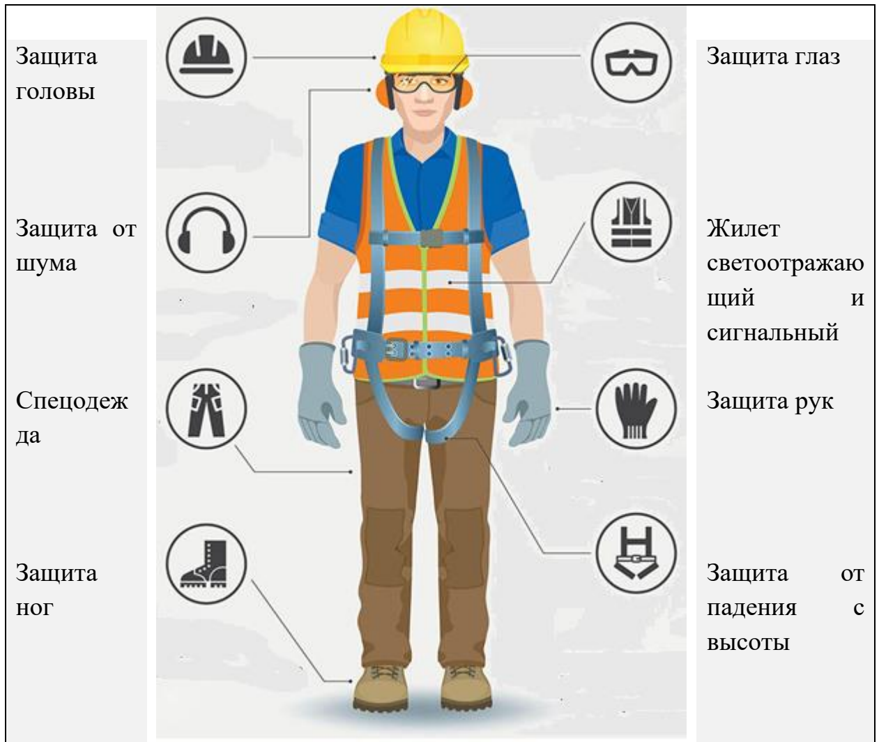
Рисунок-1. Спецодежда и СИЗ для строителей.
